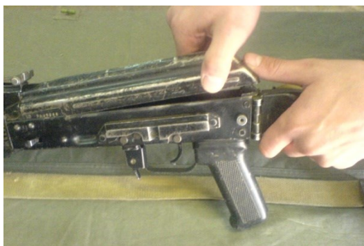
Рисунок 4 – Отделение крышки ствольной коробки
