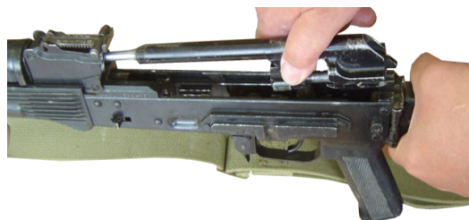
Рисунок 6 – Отделение затворной рамы с затвором
