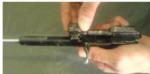
Рисунок 7 – Отделение затвора от затворной рамы
