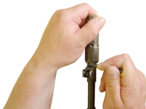
Рисунок 3 – Отделение дульного тормоза-компенсатора
