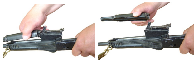
Рисунок 8 – Отделение газовой трубки со ствольной накладкой
